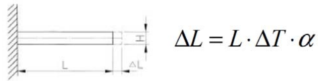
圖表 4-4 線性熱膨脹變形
